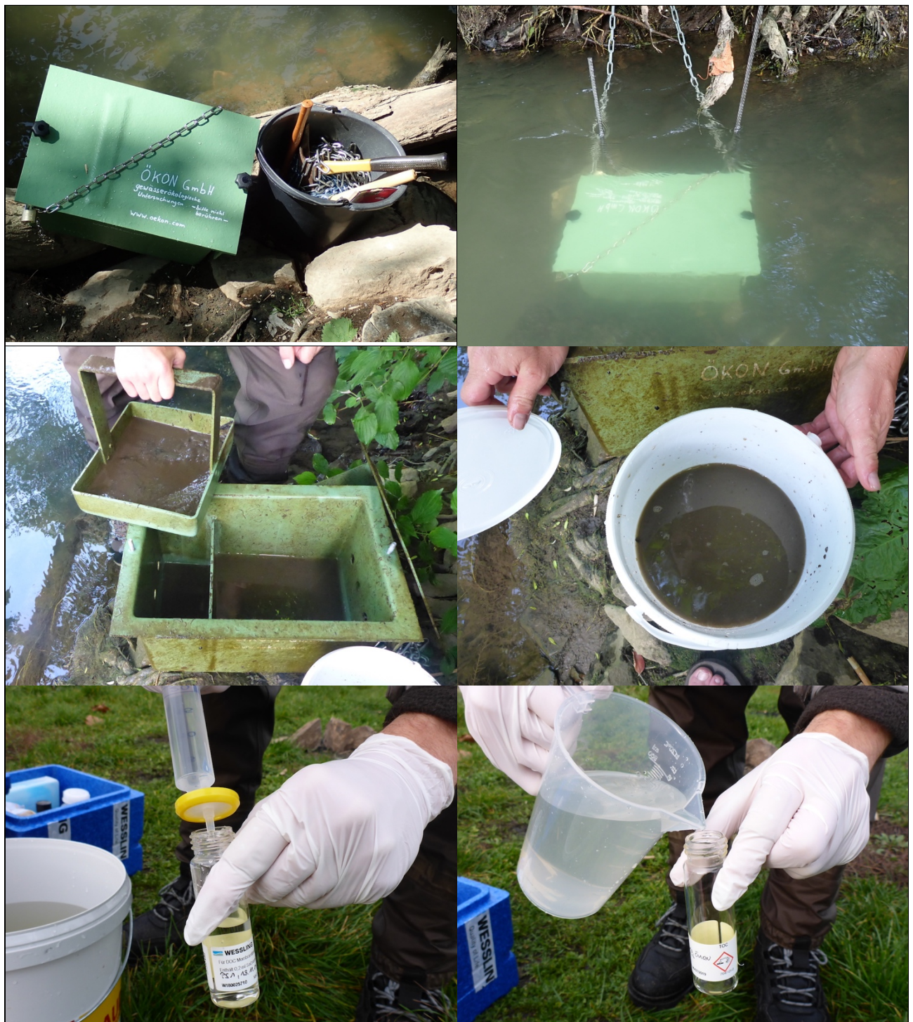
Abb. 10: Sedimentbox zum Aufsammeln der Schwebstoffe (oben links), exponiert in der Pegnitz (oben rechts). Schwebstoffentnahme aus der Sedimentbox (Mitte links & rechts). Abfüllen der Wasserproben mit vorheriger Filtration (unten links) und ohne Filtration (unten rechts).
