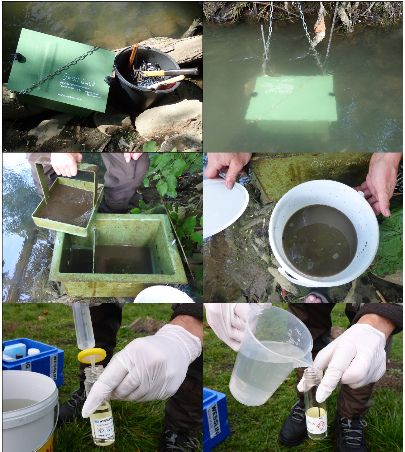
Abb. 7: Sedimentbox zum Aufsammeln der Schwebstoffe (oben links), exponiert in der Pegnitz (oben rechts). Schwebstoffentnahme aus der Sedimentbox (Mitte links & rechts). Abfüllen der Wasserproben mit vorheriger Filtration (unten links) und ohne Filtration (unten rechts).
